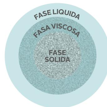
All'avanzamento del solvente nel granulo viene a formarsi uno strato gelificato, più viscoso verso l'interno e più fluido verso l'esterno. I principi attivi migrano nello strato gelificato e vengono rilasciati per diffusione.
